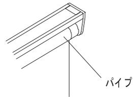
・楊枝等の先の尖ったものを生地押さえとローラーパイプの間に入れ、生地押さえを押し上げながら横にスライドさせ、スクリーンを引くと外れます。
