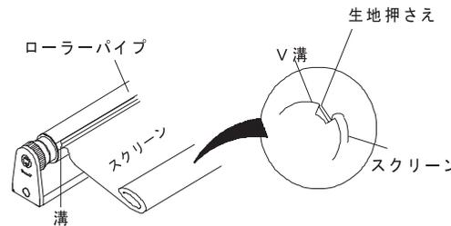
・片手で軽くスクリーンを押さえながら、反対側の手の指先で生地押さえをパイプの溝の上側に押し込んでいきます。
